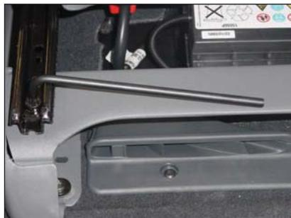
Para reinstalar o banco do condutor, proceder na ordem inversa, garantindo o aperto correto dos parafusos de fixação dos trilhos do banco. Para tal, utilizar a chave torx.
