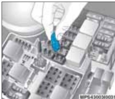
Antes de substituir um fusível, desligue o interruptor do respectivo circuito.
